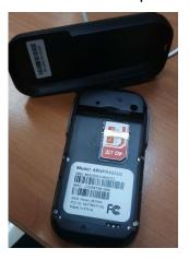
15. Procedemos a encender el modem, dejando presionado sin soltar el botón de encendido, hasta que aparezca en la pantalla Nexxt.
