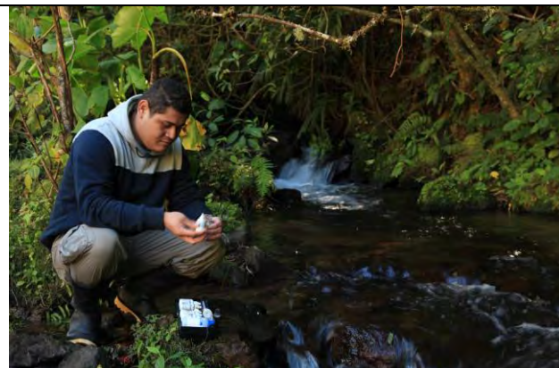
Toma de parámetros fisicoquímicos: pH, OD, Temperatura, conductividad y sólidos disueltos
